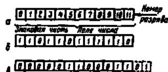
Рис. 3.2. Представление чисел в форме с фиксированной запятой
